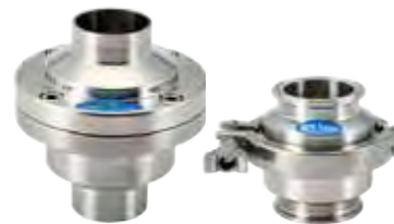
שתום אל חוזר AISI 304/316L אטם פנימי סיליקון תקן: 3A, DIN
